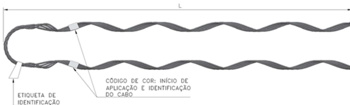
Figura 1 - Alça de distribuição em aço para condutores de alumínio nus
